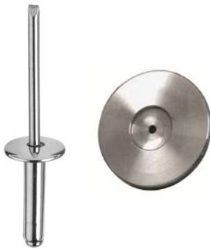
Grosskopfniet mit passendem Mundstück für flächige Abstützung auf der Plattenoberfläche
